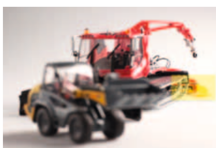
ABB. 02 Bei Brennweite 75 mm und Blende 8 lässt die Tiefenschärfe zu wünschen übrig. Die Bereiche optimaler Schärfe kann man zwar einstellen, aber diesseits und jenseits der Schärfenebene sind die Bilder unbrauchbar. Eine kleinere Blende ist hilfreich, löst aber nicht das Problem, wie Abbildung 3 zeigt. QUELLE Rainer Bernd Voges (Montage), Ulrich Thiele (Fotos)
