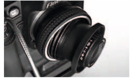
ABB. 06 Damit sich die Ebene des Aufnahme-Chips, des Kameraobjektivs und des Objekts in einem Punkt treffen und somit die Schärfe entsteht, ist das Objektiv beweglich.
