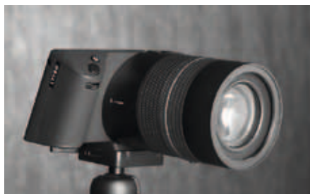
ABB. 05 Vorbildlich ist die moderne interaktive Benutzungsoberfläche des großen Rückseiten-displays. Ansonsten kommt die Lichtfeldkamera eher konventionell daher. Einziger Anbieter ist derzeit die Firma Lytro. QUELLE Ulrich Thiele
