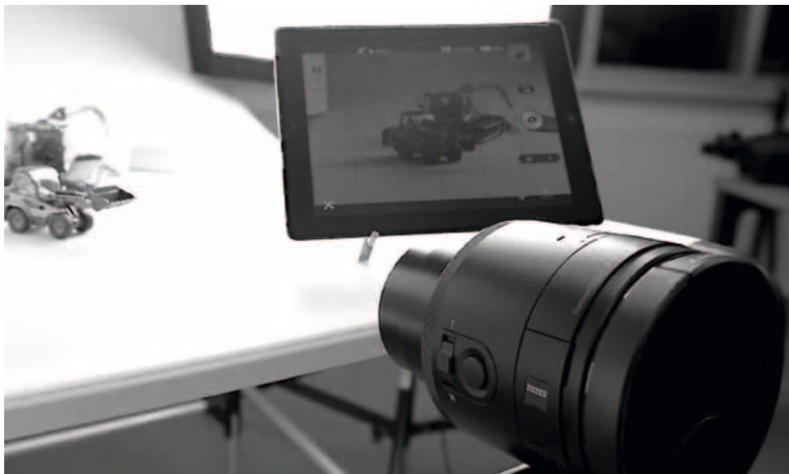
ABB. 16 Ultimate Entfesselung: Die Sony-Kameras kommen ganz ohne Bedienelemente aus – abgesehen von Einschalter, Ladebuchse und ein paar unwesentlichen „Notknöpfen“. QUELLE Ulrich Thiele
